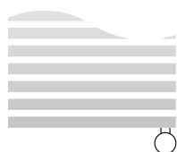
[Rysunek 7 – podłączenie grzałki od dołu, pionowo, przy poziomych rurkach poprzecznych grzejnika] Podłączenia E1, E8, EX
